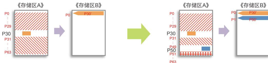
在这个案例中，只将想改写的存储区AP30(■ 颜色部分)，作为New Page(P30)写入迁移目标的存储区B的第1页(P0)，结束Write动作。也就是说，不会像一般方式那样复制改写对象页面前的页面，维持2个存储区的状态，等待下次写入。
