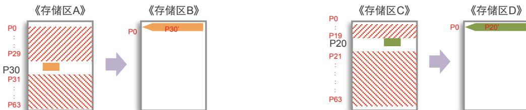
另一方面，当下次想改写的不是存储区A，而是别的存储区时，例如想改写存储区C的P20内的数据(■ 颜色部分)时，在维持存储区A和存储区B的2个存储区的状态，准备迁移目标存储区D，将第1页(P0)作为New Page(P20')，写入该页。
