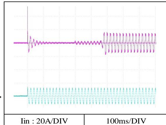
**2.6 入力電流波形 Input current waveform**
