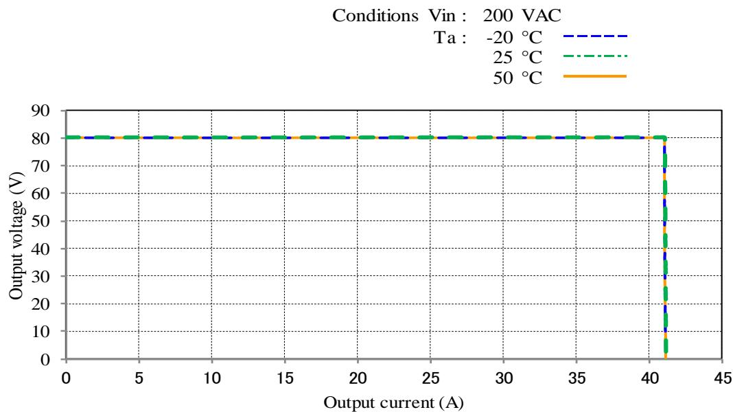
**2.4 過電壓保護特性 Over voltage protection (OVP) characteristics**
