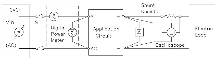
(10) 入力サージ電流（突入電流）特性 Inrush current characteristics
