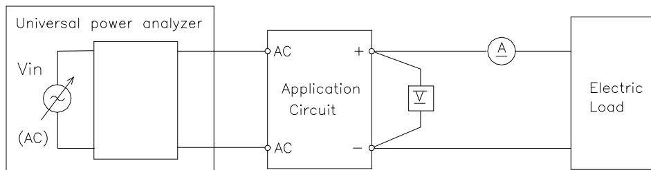
(13) リーク電流特性 Leakage current characteristics
