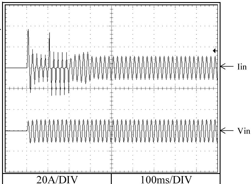
**2.12 入力サージ電流（突入電流）波形**
