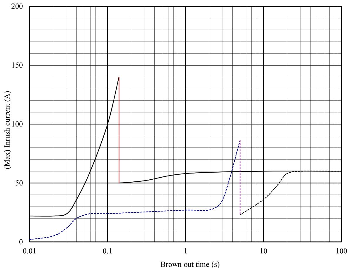
**2.12 入力サージ電流（突入電流）波形**
