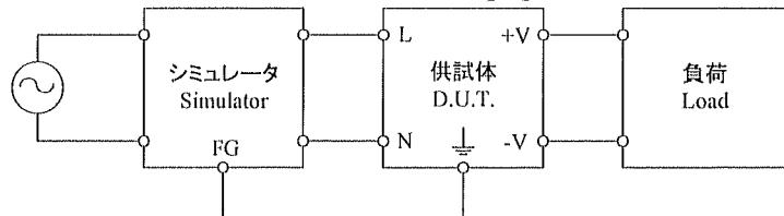
シミュレータ : INS-400L (ノイズ研究所)
