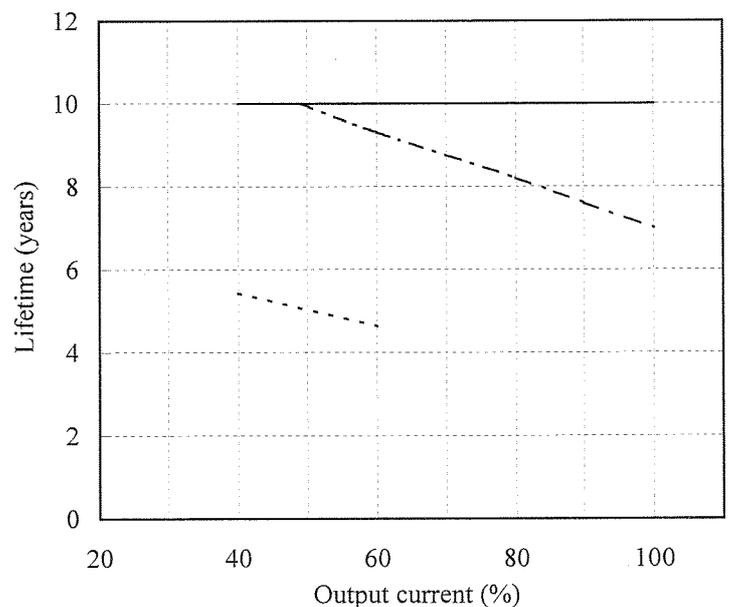
電解コンデンサ推定寿命計算値 Electrolytic capacitor lifetime
