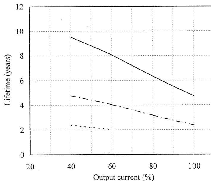
電解コンデンサ推定寿命計算値 Electrolytic capacitor lifetime
