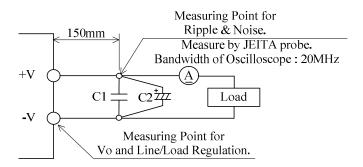
C1 : Film Cap.  $0.1\mu F$ C2 : Elect. Cap.  $47\mu F$
