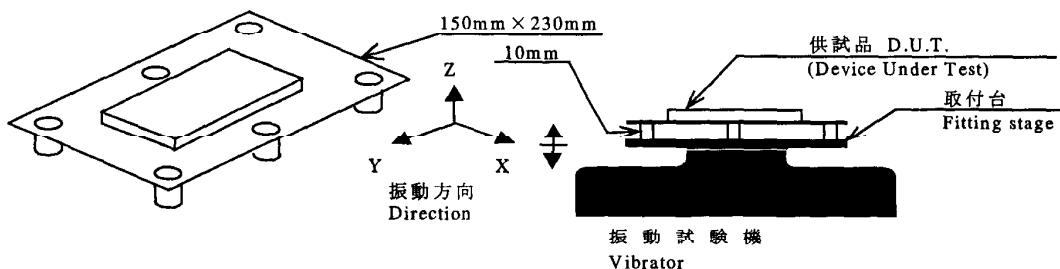
供試品を基板に取付け(M3ビスで4箇所固定)、それを取付台に固定する。
