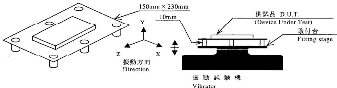
供試品を基板に取付け(入出力信号ピンをはんだ付け、M3取付用タップの4箇所をビスにより固定)、それを取付台に固定する。
